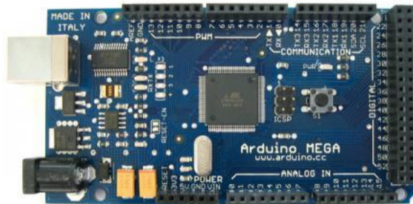
Рисунок 1 – Друкована плата Arduino
