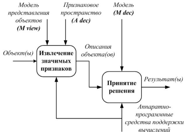
Рис. 2 – Модель процесса эксплуатации систем обнаружения ВП
