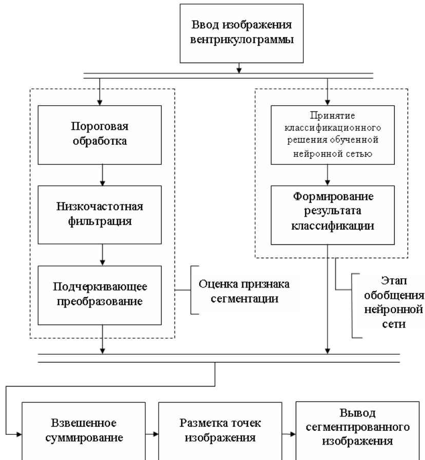
Рис. 1 – Функциональная схема метода выделения контуров ЛЖ на вентрикулограмме
