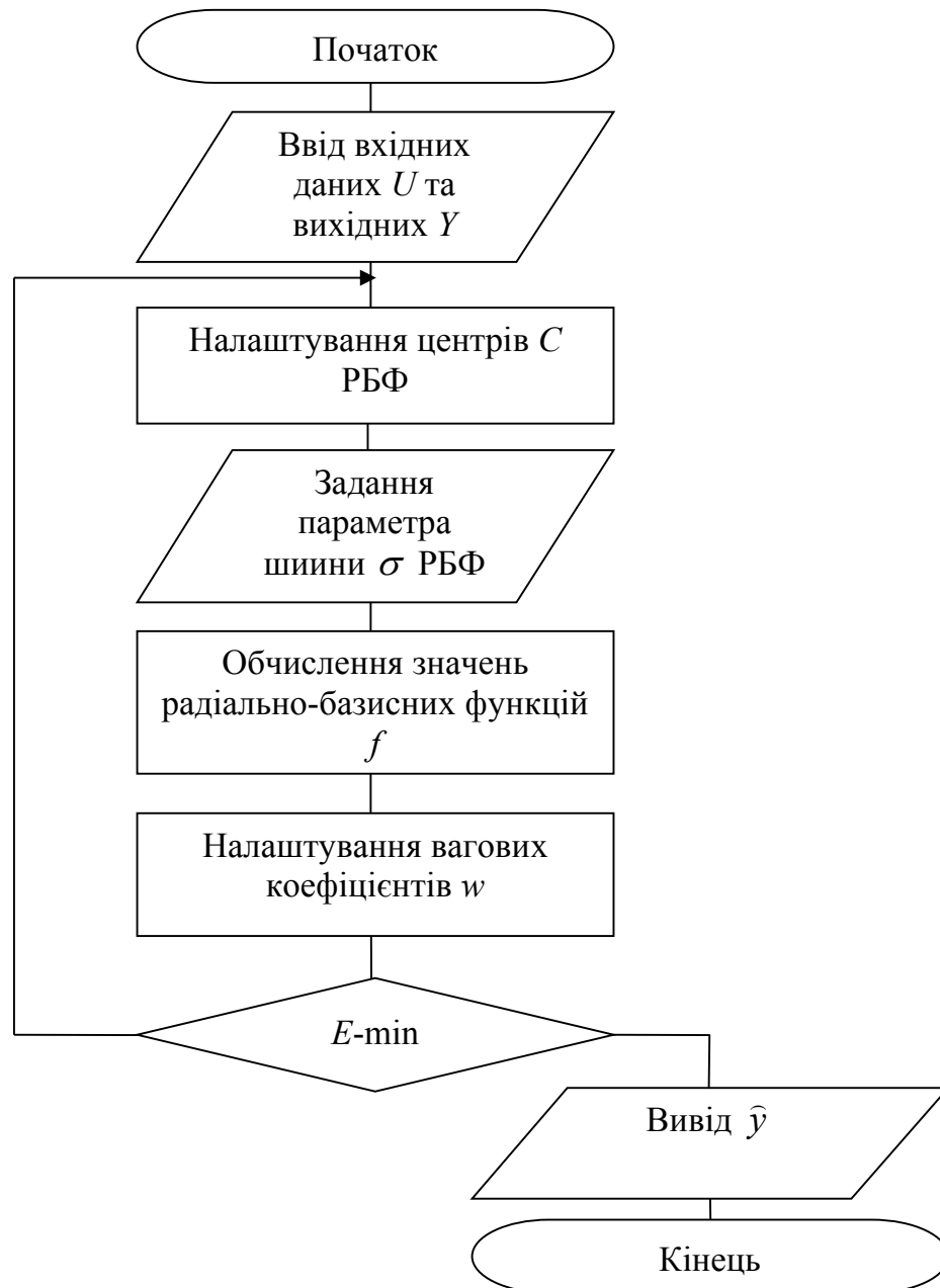
Рисунок 2.3 – Блок-схема алгоритму прогнозування індикаторів економічної безпеки регіону
