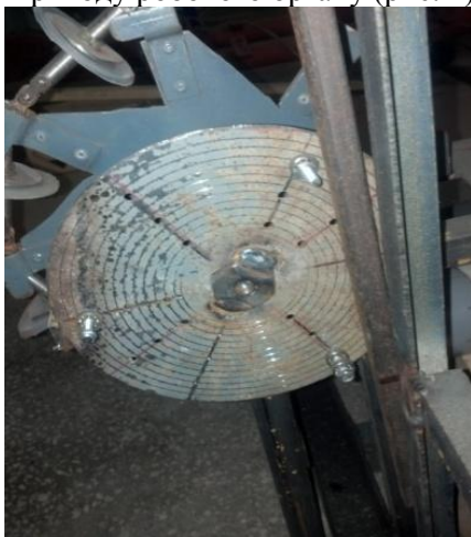
Рис.2. Привідний обертовий диск процесу транспортування сипких матеріалів
