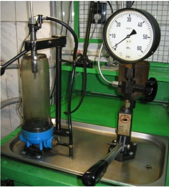
Рис. 1. Прилад для перевірки і регулювання форсунок Bosch EFEP 60Н
