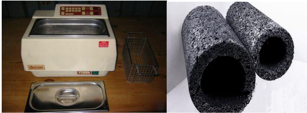
Рис.3. Зовнішній вигляд ультразвукової ванни моделі DECON FS-100 B та фільтрувального елемента
