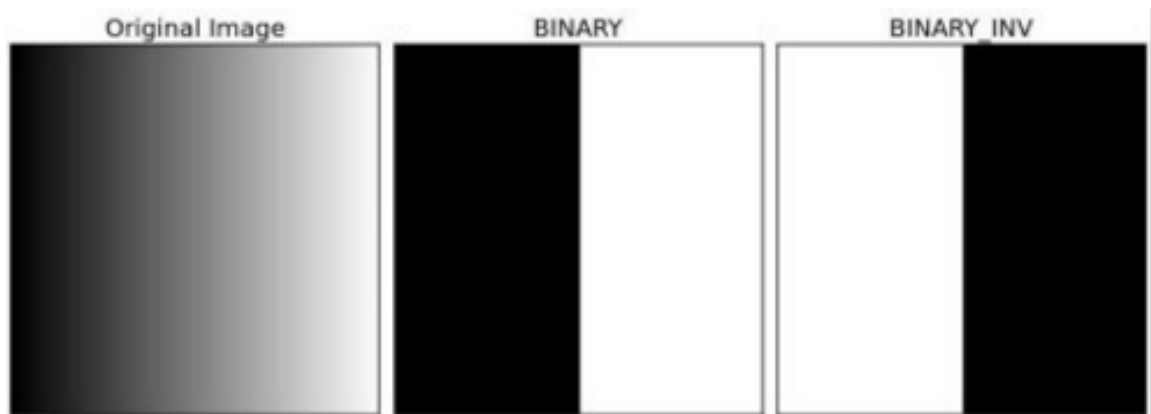
Рисунок 1.10- Приклад роботи методів бінаризації. Binary - метод з нижнім порогом; Binary_inv - метод з верхнім порогом
