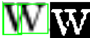
Рисунок 3.4 – Приклад символу з дефектом друку, який привів до помилки виділення
