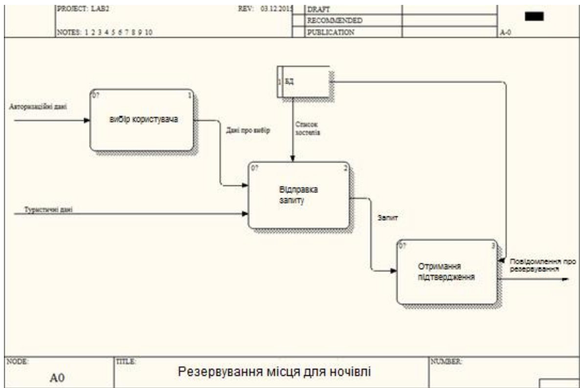
Рисунок 2.5 - Структура декомпозиція діаграми DFD
