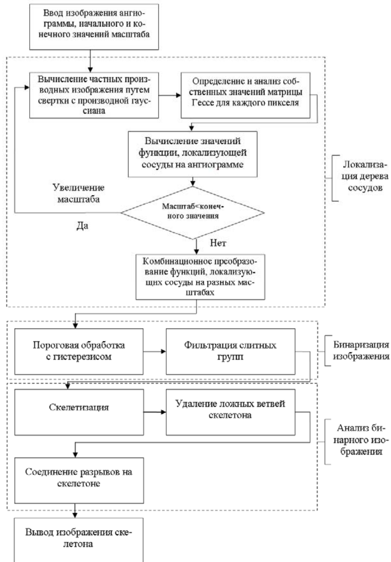
Рис. 2 – Функциональная схема метода сегментации изображений сосудов на ангиограммах работы [4] и анализа результата сегментации
