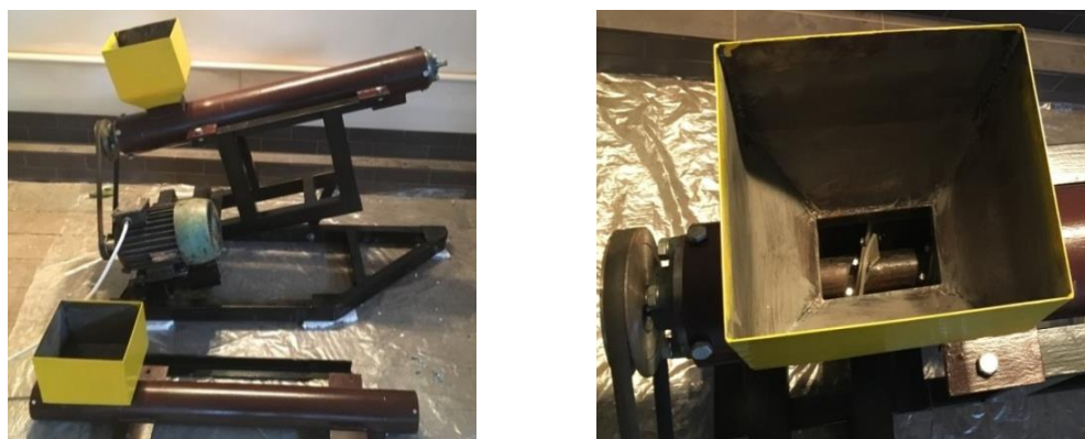
Рис.3. Експериментальна установка для проведення досліджень секційних еластичних шнекових робочих органів: а – схема установки; б – загальний вигляд
