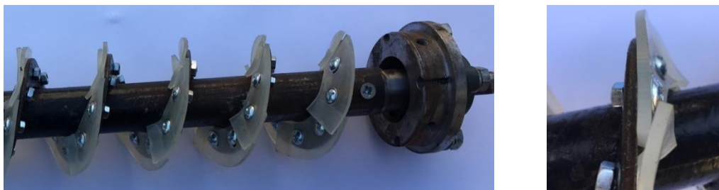
Рис.2. Спосіб виготовлення шнека з еластичною гвинтовою поверхнею: а – навита металева смуга на ребро в пакет; б - виконані отвори рівномірно по діаметру по периферії навитої металевої смуги на ребро в пакет; в – відкалібрована спіраль розташована на валу; г – приварена спіраль до валу; д – еластичні секції, які встановлені з перекриттям країв
