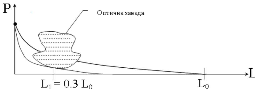
Рис. 2.21. Схема розширення потужності оптичного променя.
