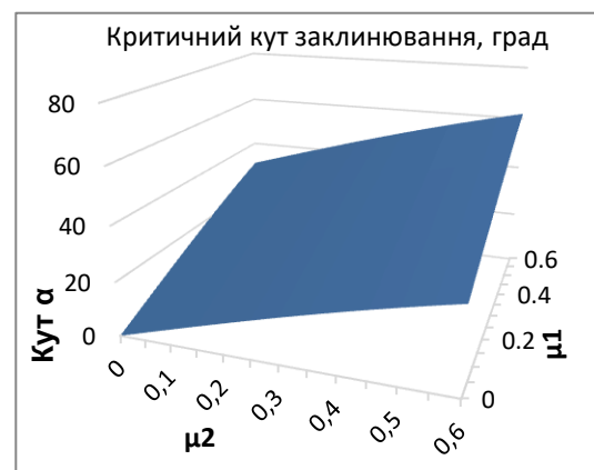
Рис.4. Залежність кута заклинювання від величини коефіцієнтів тертя \mu_1 і \mu_2
