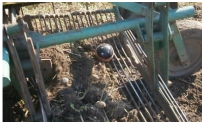
Рисунок 5. Фото імітатора коренебульбоплоду при визначенні ступеня пошкодження бульб картоплекопачкою грохотного типу в польових умовах
