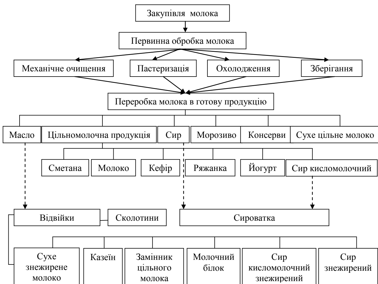
Рис. 1. Процес технологічної переробки молока
