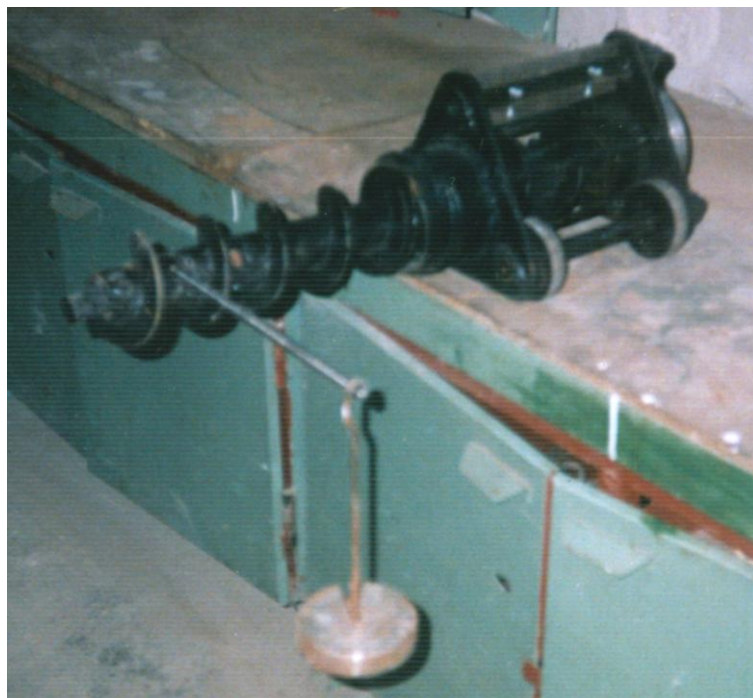
Рис. 3.5. Загальний вигляд навантаження шнека завантажувального патрубку тарувальним важелем
