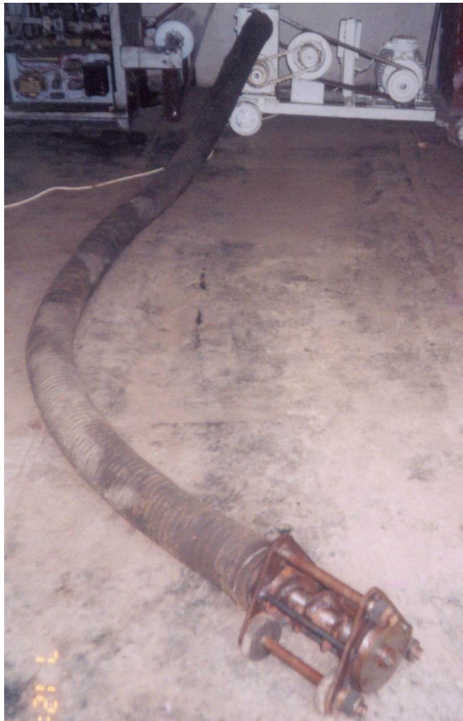
Рис. 3.10. загальний вигляд експериментальної установки гнучкого гвинтового конвеєра із завантажувальним патрубком
