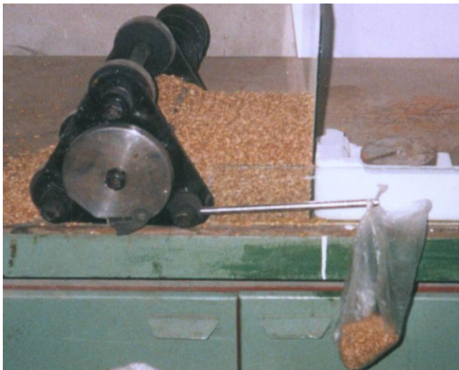
Рис. 3.16. Загальний вигляд проведення експерименту при визначенні крутного моменту для зрушення сипкого середовища:
