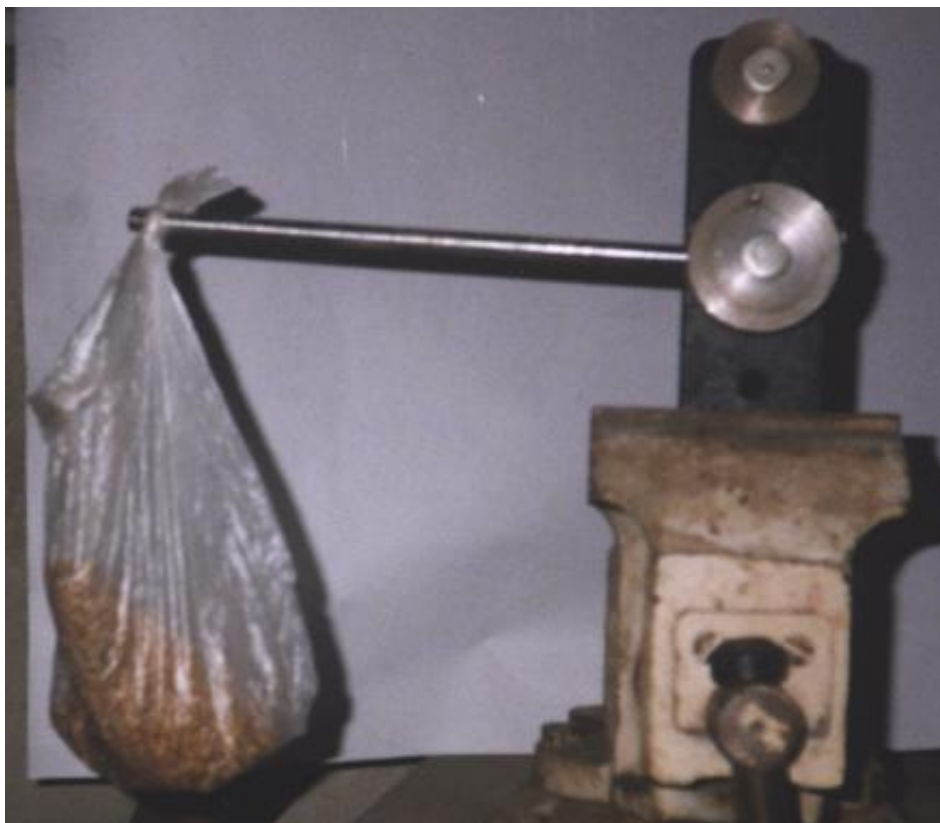
Рис.3.7. Загальний вигляд установки з шарнірно-важільним механізмом повороту активатора
