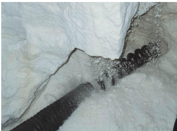
Рис. 1.12. Забір за допомогою спіралі шнека
