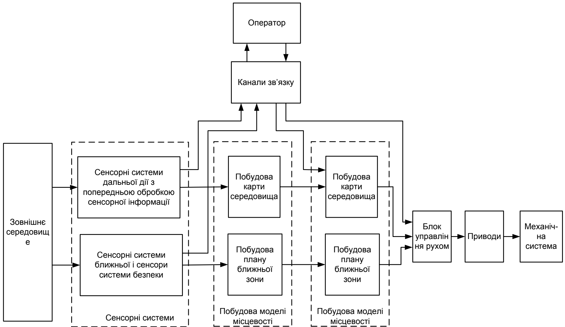
Рисунок 1.8 – Функціональна схема системи управління рухом по місцевості мобільного робота
