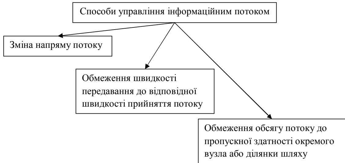
Рис. 1.1. Способи управління інформаційним потоком
