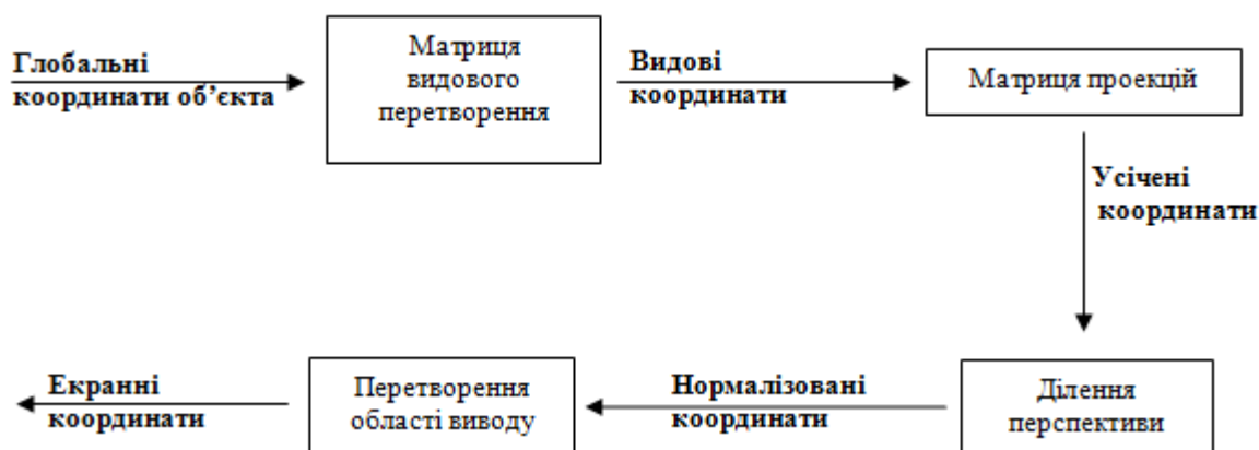
Рисунок 4.3 – Процес виведення тривимірної графіки в OpenGL
