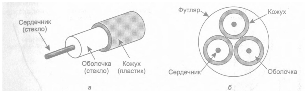
Рис. 2.6. Видгляд одиночного волокна збоку (а); поперечний перетин трижильного кабелю (б)
