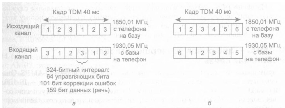
Рис. 2.36. Канал D-AMPS з трьома абонентами (а); канал D-AMPS з шістьма абонентами (б)
