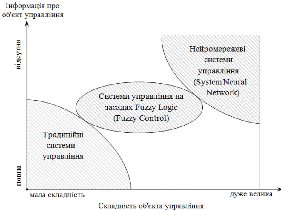
Рис. 2. Области ефективного застосування нечіткої логіки і штучних нейронних мереж для управління складними об'єктами
