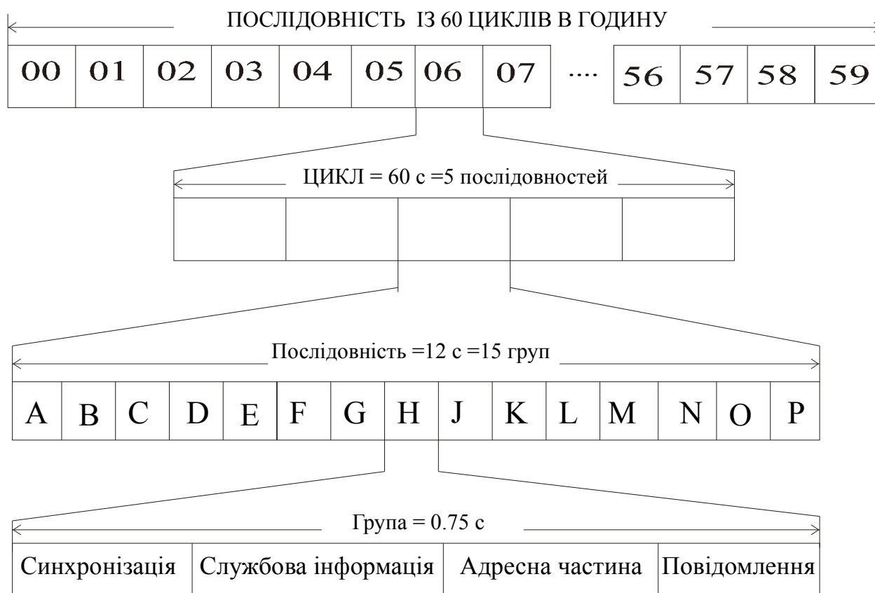
Рис.13.1. Структура протоколу ERMES
