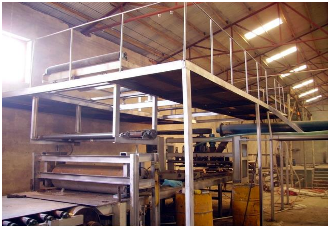
Рис. 3.4. Лінія з виробництва листів гіпсокартону
