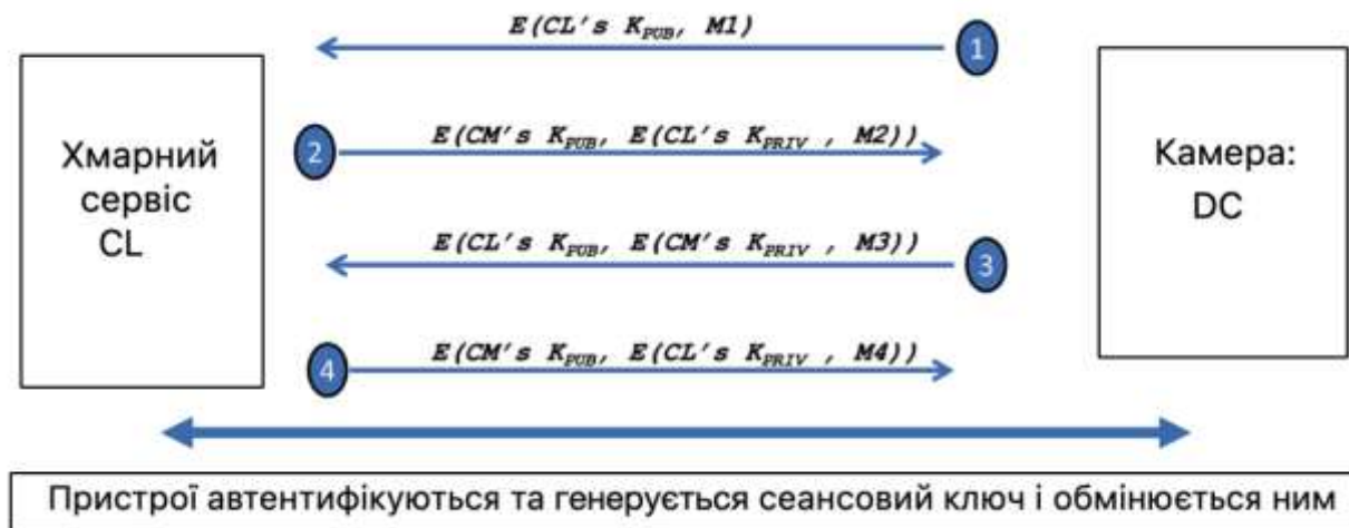
Рисунок 3.2 – Протокол автентифікації та керування сеансом
