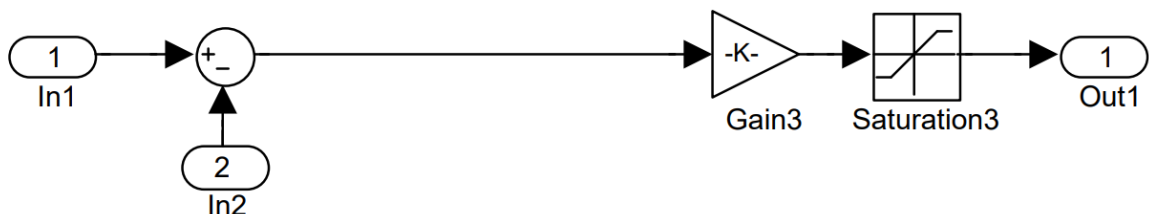
Рисунок 3.10 – Схема регулятора подачі повітря у вигляді підсистеми Simulink (Subsystem6)
