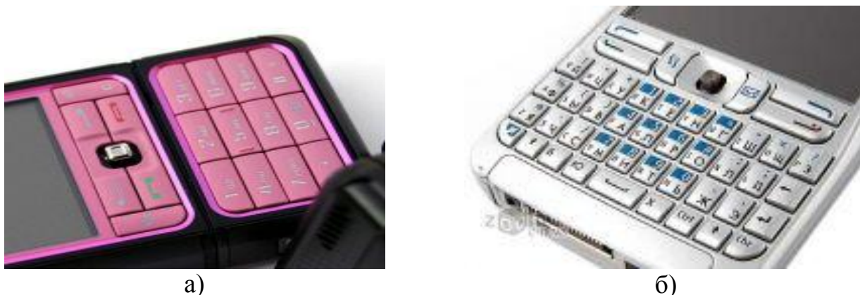
Рис.1.13. а) цифрова клавіатура, б) QWERTY – клавіатура.
