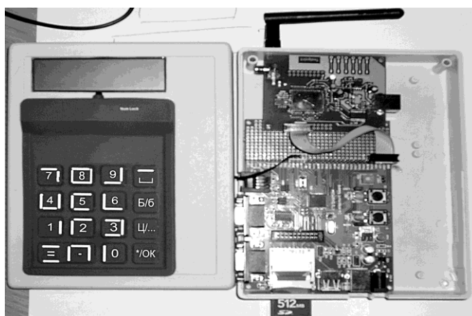
Рис. 4.12. Реалізація дослідного взірця мобільного адаптера СД (Патент України на корисну модель №25291).
