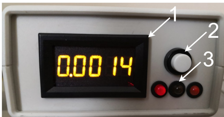
1) індикатор амперметра струму подразнення, 2) вимикач початку роботи 3) світлодіодна індикація пристрою
