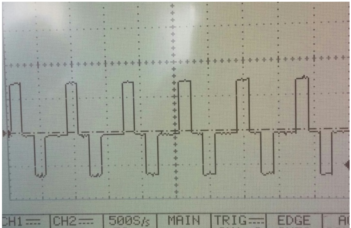
Рис. 3.11. Осцилограма функціонування генератора струму із програмним управлінням для подразнення тканин хірургічної рани
