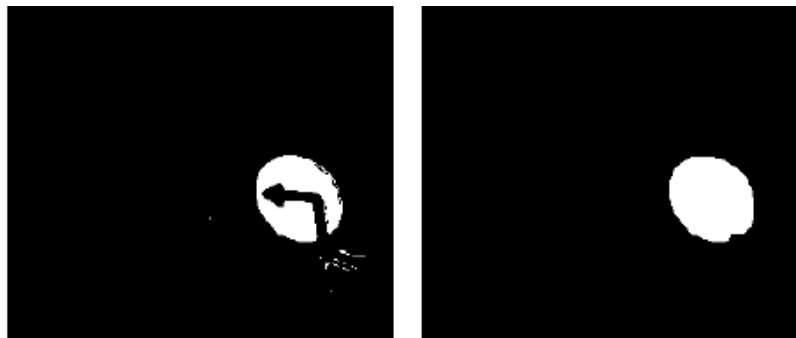
Рисунок 3.6- Виділення області знака (зліва - до застосування морфологічних операцій; праворуч - після застосування морфологічних операцій)
