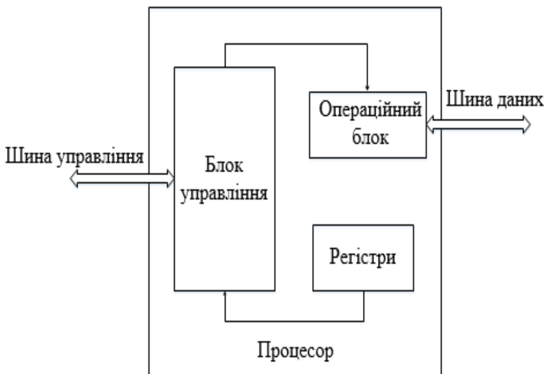
Рисунок 3.4 –Архітектура центрального процесора
