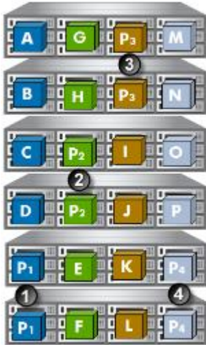
Мал. 7. Розміщення блоків даних усередині кластера StoreVirtual з шести вузлів, якщо для логічного диска обраний Network RAID 6
