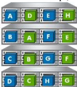
Мал. 3. Розміщення блоків даних у середині кластера StoreVirtual з чотирьох вузлів, якщо для логічного диска обраний Network RAID 10
