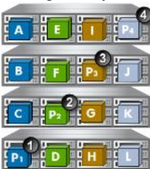
Мал. 6. Розміщення блоків даних усередині кластера StoreVirtual з чотирьох вузлів, якщо для логічного диска обраний Network RAID 5
