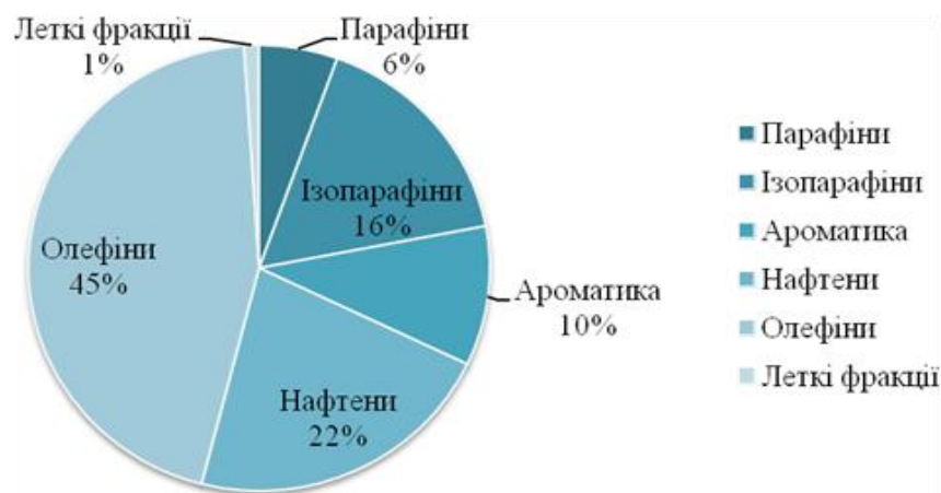
Рис. 8. Ваговий вміст (у %) вуглеводнів у пробі бензину, неочищеного (фракція бензину при 100 < t^{\circ} < 150 )
