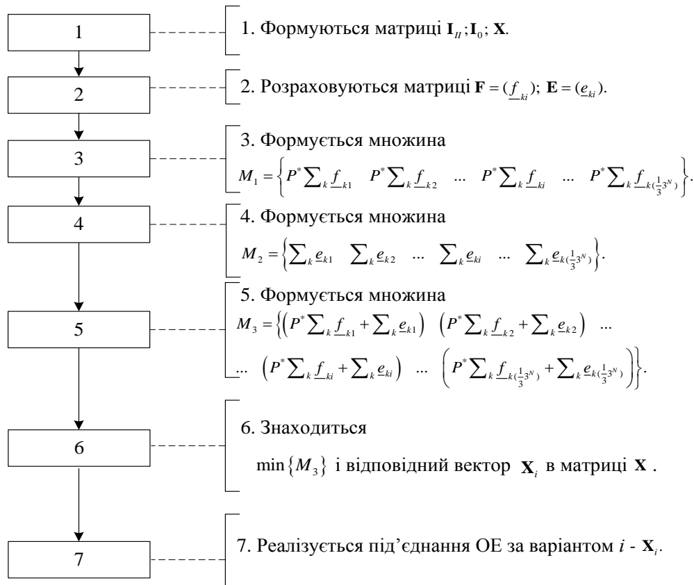
Рис. 1. Алгоритм розрахунку оптимального варіанту внутрішнього симетрування ОЕ у вузлі чотирипровідної мережі
