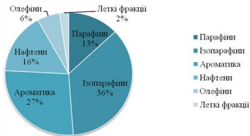
Рис.10. Ваговий вміст (у %) вуглеводнів у пробі бензину, очищеного сапонітом, обробленим ПДМС (фракція бензину при 70 < t^{\circ} < 100 )
