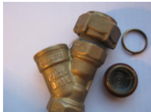
Рис. 2. Загальний вигляд елементів фільтра грубої очистки води
