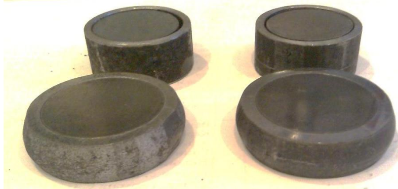
Рис. 5. Зразки на основі залізу з добавкою графіту 1,6 % в обичайці (вихідні та після осадки при зусиллі 600 кН)
