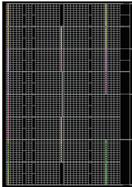
Рисунок 4.33 - Топологія ПЛІС на якій розміщено реалізовану систему.
