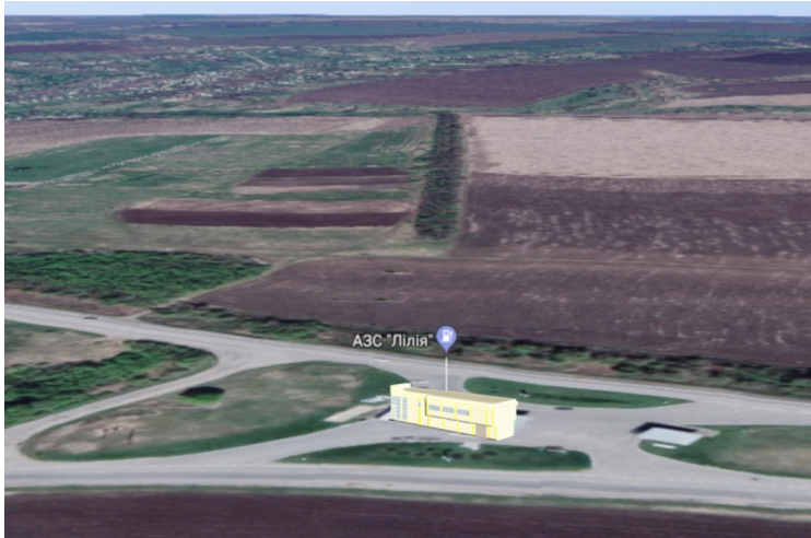
Рисунок 4 – Вигляд тривимірної моделі, суміщеної з ортофоторізнімком місцевості
