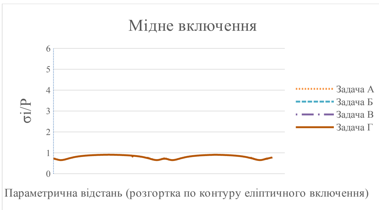
Рис. 3 Розподіл відносної інтенсивності напружень при «м'якому» включенні у задачах А-Г
