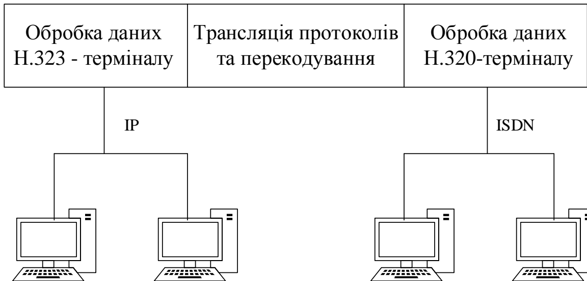
Рисунок 1.2 -Функції шлюзу між ISDN і ЛОМ-терміналами
