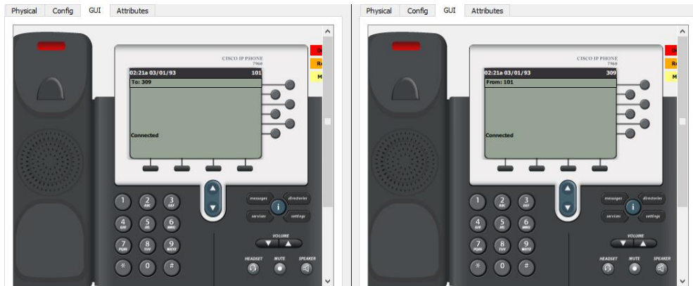
Рисунок 3.20 —Перевірка виклику між підмережами 1-го та 3-го офісів
