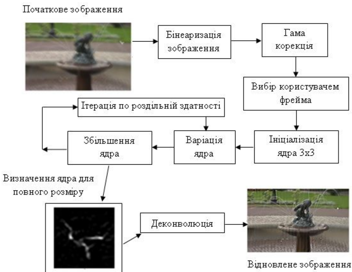
Рисунок 2.13 – Структурна схема алгоритму деконволюції розмитих зображень.
