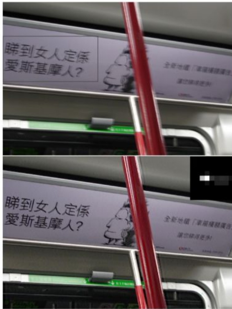
Рисунок 2.4 – Верхій рисунок – сцена з невеликим розмиттям і обраний користувачем фрейм з написом ієрогліфами, обведений сірим прямокутником. Нижній рисунок –результат роботи алгоритму та отриманим ядром розмиття.
