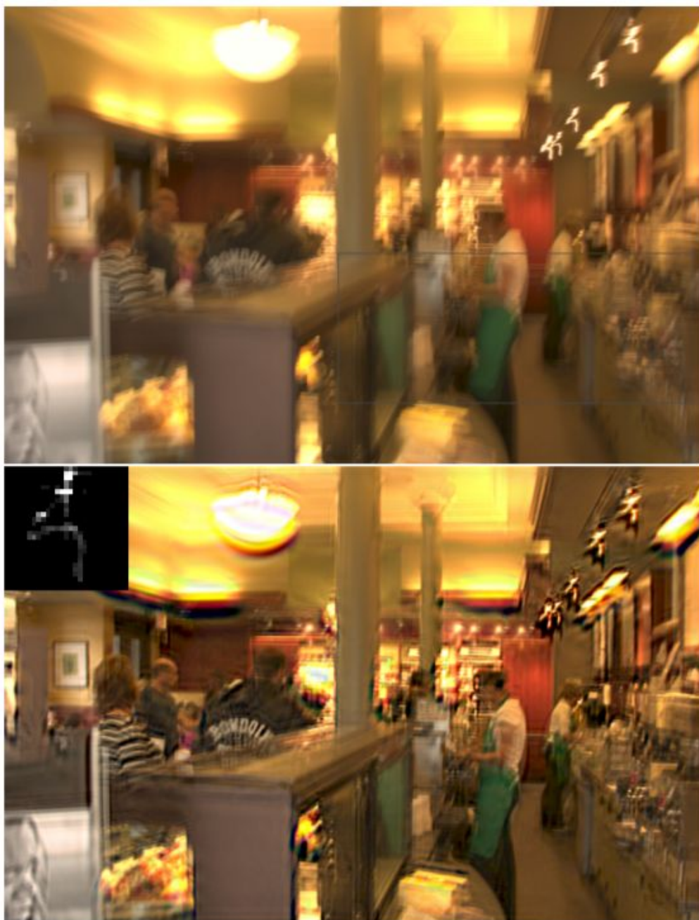
Рисунок 2.12 – Верхня частина: розмита сцена з сильною насиченістю, знята з 1-но секундною експозицією. Внизу: вивід результату алгоритму відновлення.
