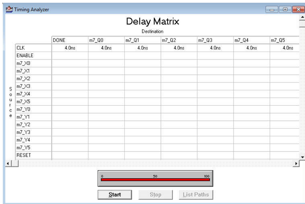
Рисунок 3.12 – Час отримання сигналу на виході суматора по модулю 61
