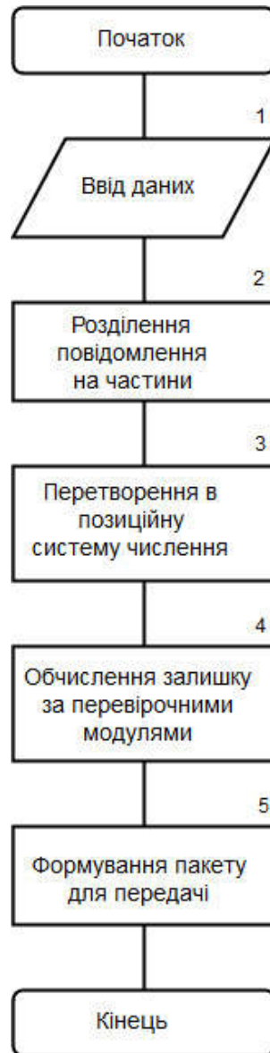
Рисунок 2.1 – Алгоритм формування перевірочних символів
