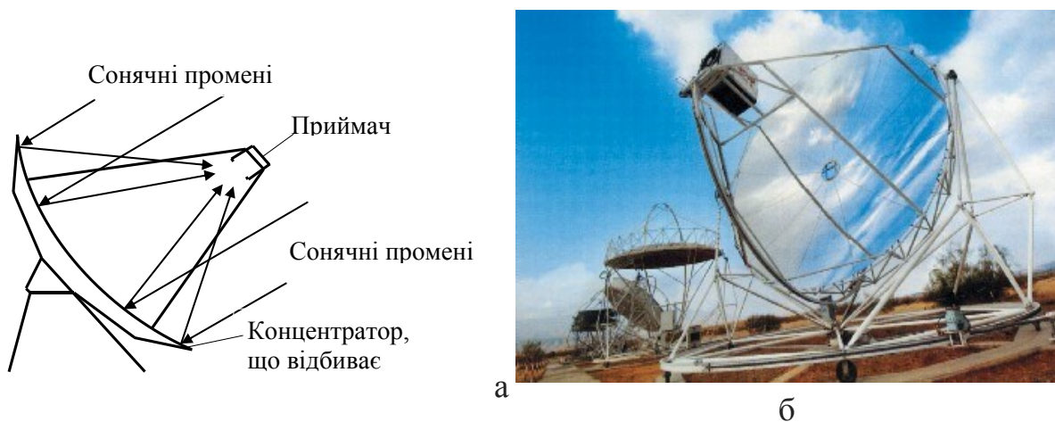
Рис. 4.10. Сонячна установка тарілкового типу: а – схема сонячної установки тарілкового типу; б – сонячна установка потужністю 10 кВт.
