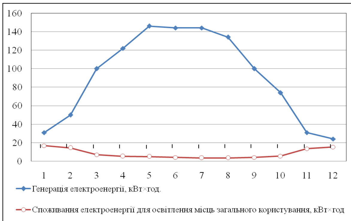
Рис. 3.6. Зміна величини генеруючої потужності сонячних батарей і спожитої електроенергії залежно від пори року: 1 – січень – 12 – грудень
