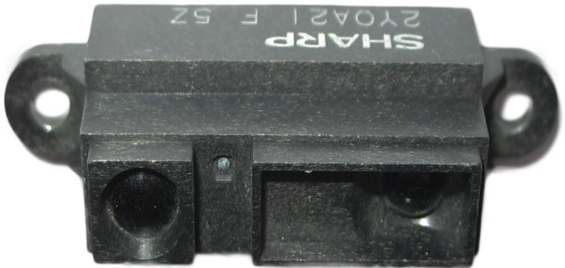
Рисунок 1.2 – Оптичний інфрачервоний далекомір Sharp 2y0a21
