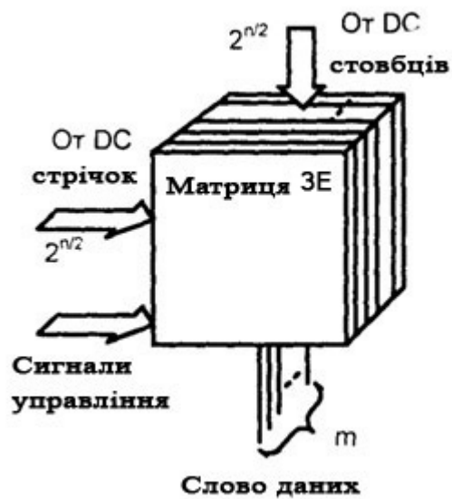
Рисунок 2.13 – Структура ЗП типу 3D з багаторозрядною організацією
