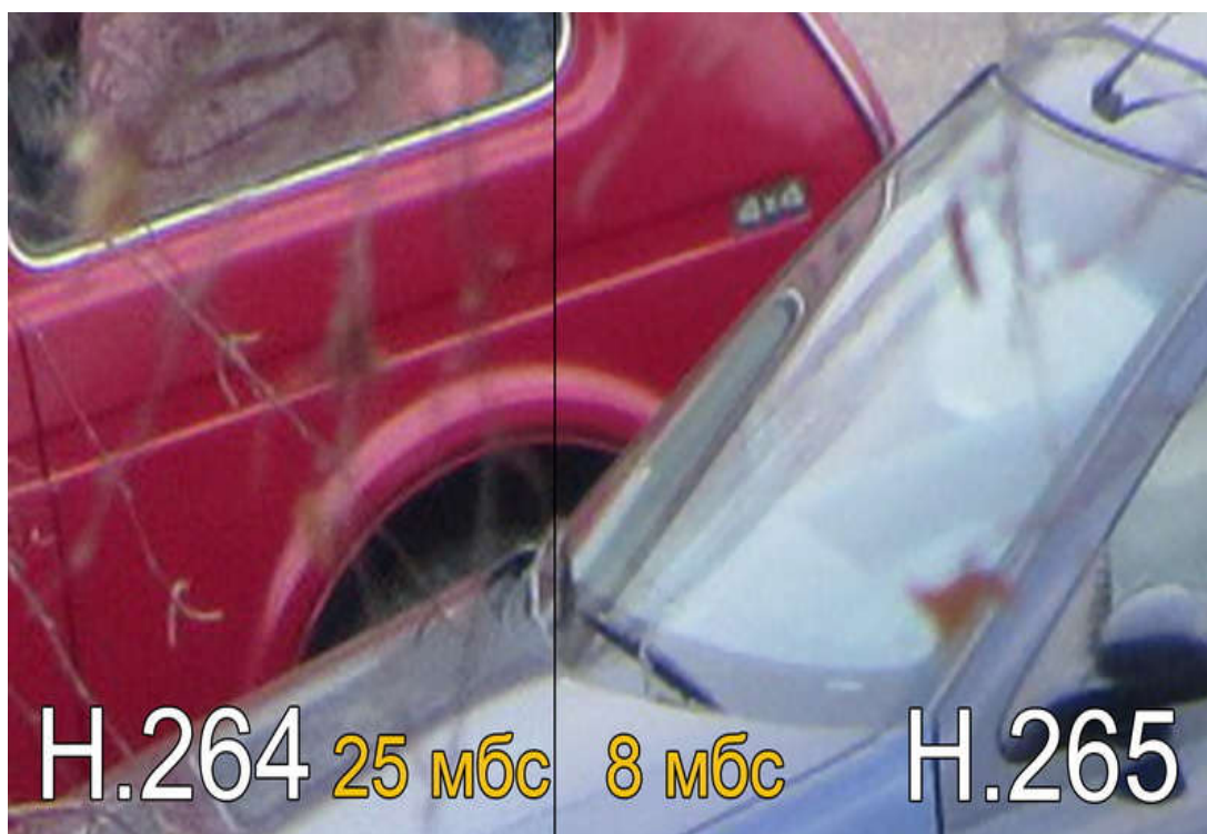
Рисунок 2.12 – Тестування алгоритмів з різним бітрейтами
