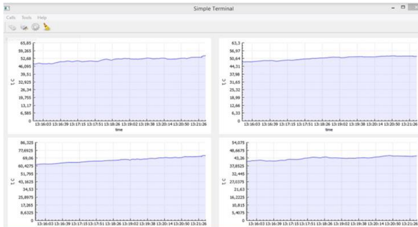
Рис. 2 Підсистема моніторингу температури робочої поверхні: програмна частина
