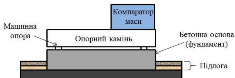
Рис.1. Схема встановлення компаратора маси на опорному камені
