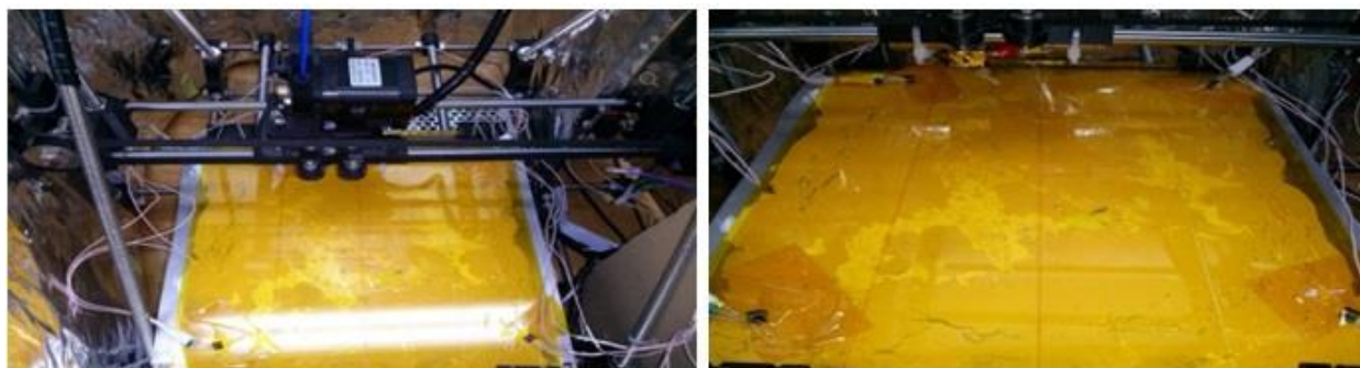
Рис. 1. Підсистема моніторингу температури робочої поверхні: апаратна частина
