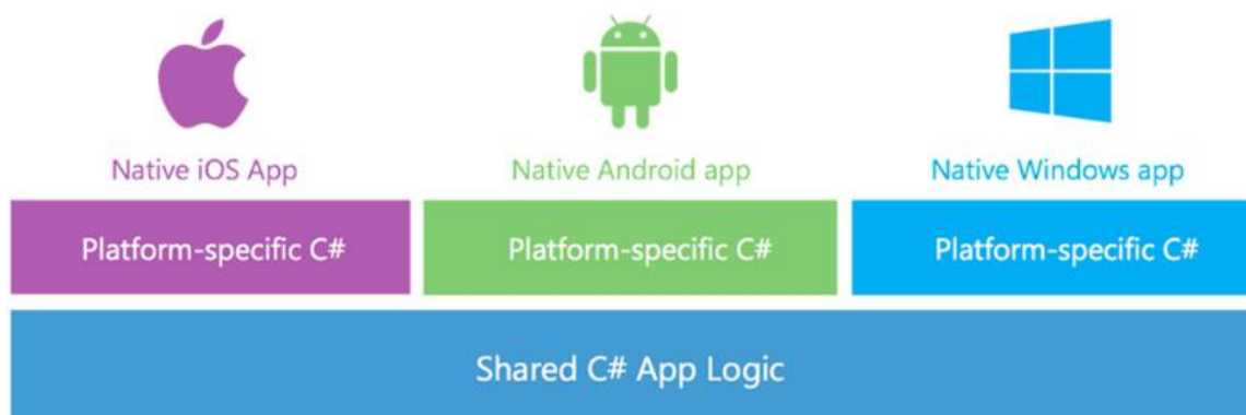
Рис 3.12 Архітектура системи на базі технології Xamarin.
