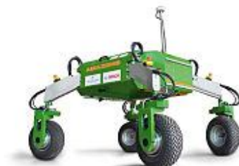
Рис.1.4 - «BoniRob» — прототип автономного польового робота компанії «Amazonen-Werke»
