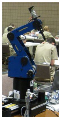
Рис.1.1- Навчальний робот-маніпулятор SCORBOT-ER 4u
