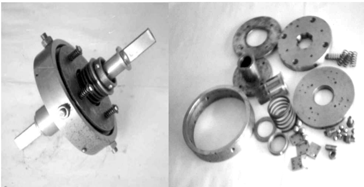
Рис. 3.13. Загальний вигляд низькодинамічної кулькової запобіжної муфти з радіальними елементами зачеплення
