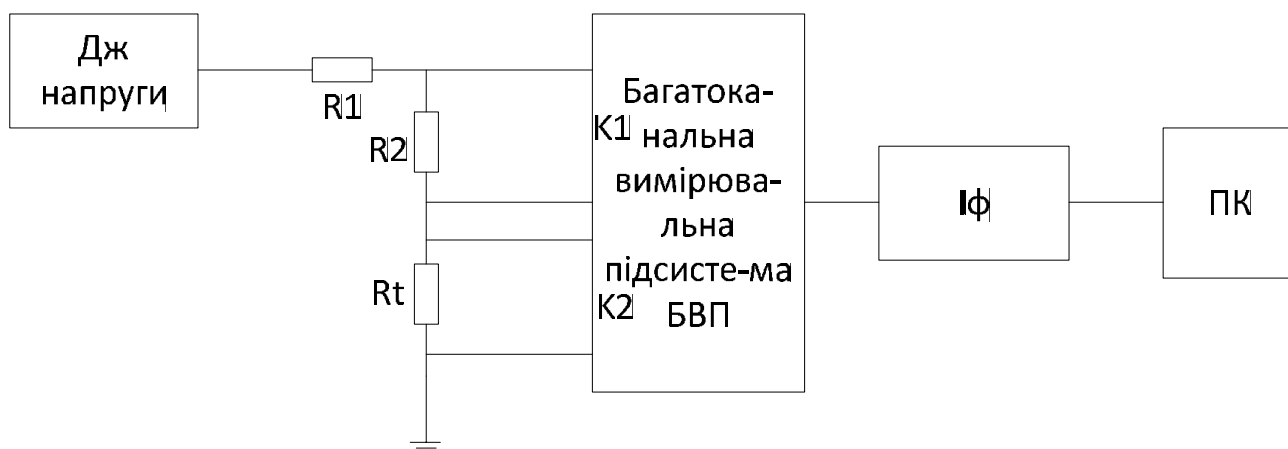
Рисунок 2.4 – Структурна схема кола вимірювання температури в термостаті
