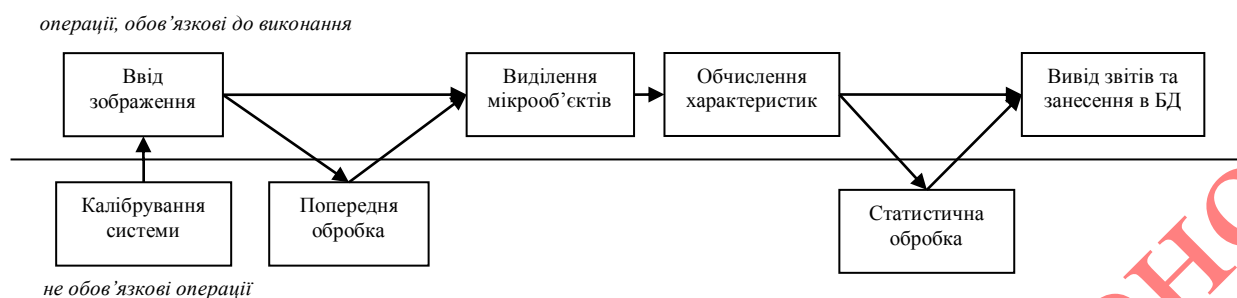
Рисунок 5 – Схема функціонування системи автоматизованої мікроскопії
