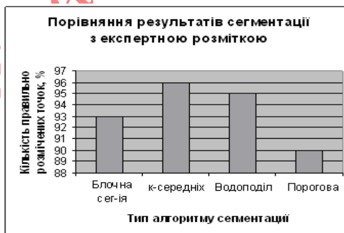
Рисунок 4.9 – Порівняння точності роботи алгоритмів сегментації
