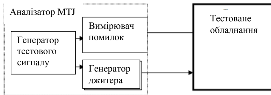
Рисунок 3.5 - Схема організації вимірювань параметра МТД (за критерієм виникнення помилок)
