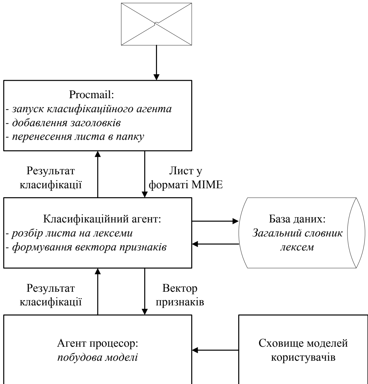
Рисунок 3.3 – Стадії класифікації системи фільтрації пошти
