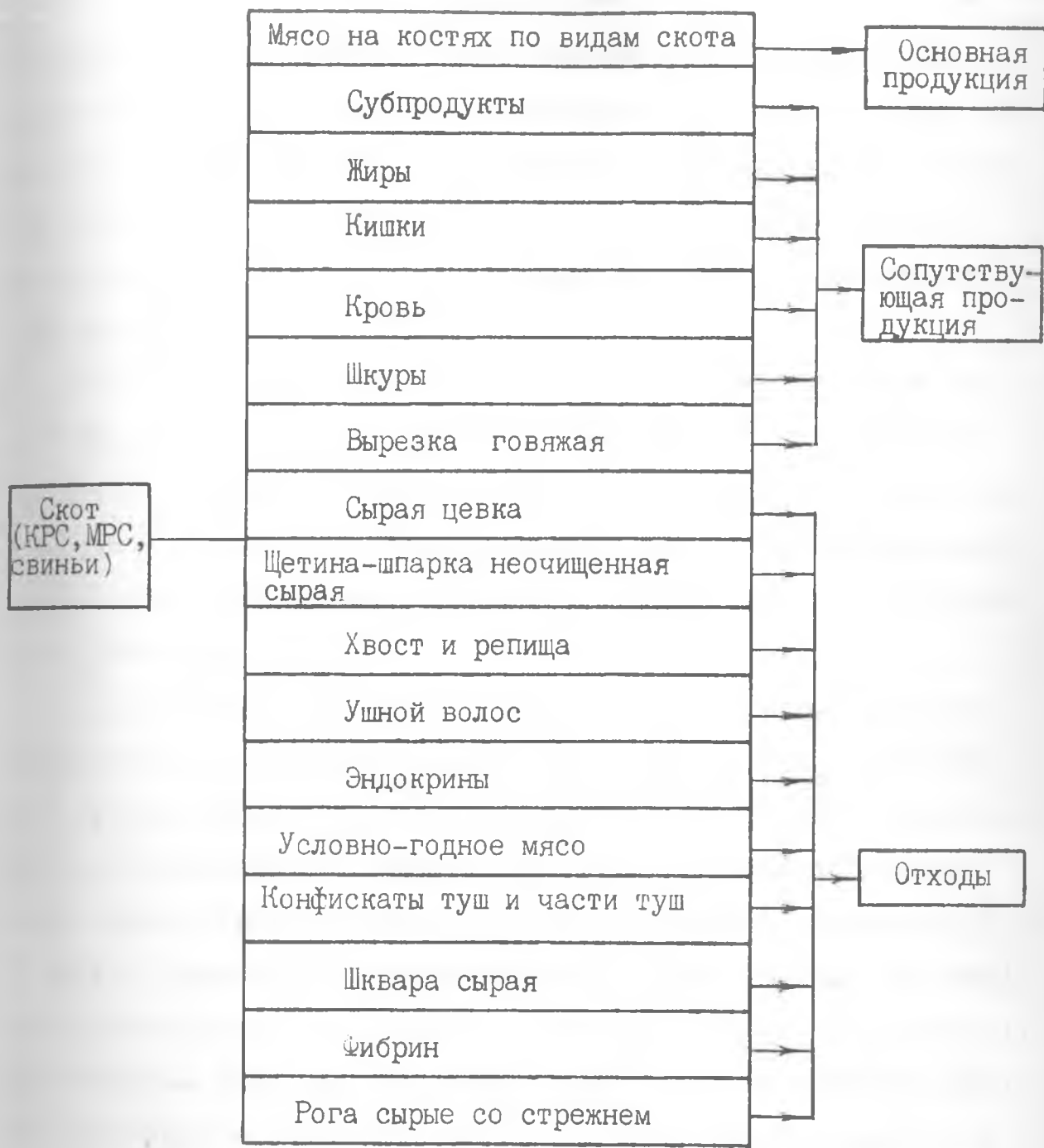
Рис. 1.2. Выход продуктов в мясожировом производстве в процессе комплексной переработки сырья
