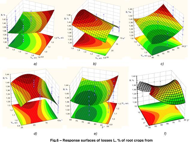
a):  $L = f(V_m, V_c)$ ; b):  $L = f(V_m, \alpha)$ ; c):  $L = f(V_m, \beta)$ ; d):  $L = f(V_c, \alpha)$ ; e):  $L = f(V_c, \beta)$ ; f:  $L = f(\alpha, \beta)$
